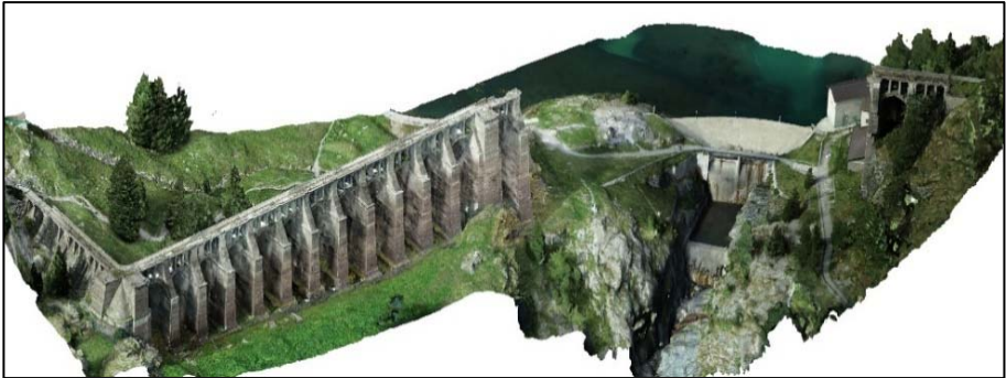
Fig. 3 – Ortofoto 3D realizzata tramite ricostruzione di un modello fotogrammetrico sulla base dei dati acquisiti con Sistema Aereo a Pilotaggio remoto. R. Folli (2023)
