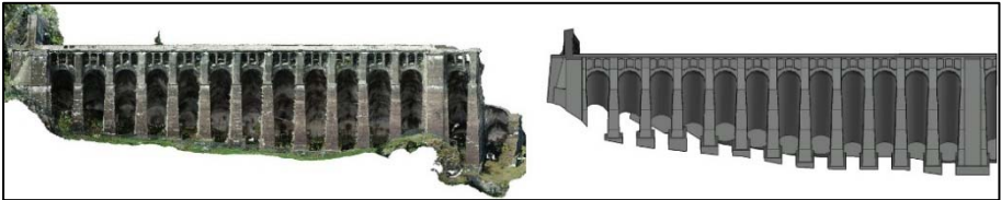
Fig. 4 – Rappresentazione grafica del modello 3D fotogrammetrico (sinistra) e del modello geometrico 3D (destra)
